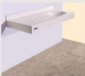
**40.130** PuSiCo - Lavabo suspendu et table à langer en pierre acrylique, avec un évier thermoformée de 90mm de profondeur, positionnable à droite ou à gauche, voile avant, dossier arrière, supports de fixation. Dimensions (LxlxH) 1400x530x200mm. Poids 24kg. Robinets exclus.
