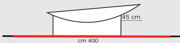
NiDondolino est un jeu adapté à tous les enfants 0+ avec un mouvement de balancement, d'inclinaison et de rotation, pour intérieur et extérieur. NiDondolino doit être placé sur une surface plane recouverte d'un matériau antichoc, exempt d'obstacles naturels ou artificiels (UNI EN 1176-1). La structure est conçue pour le serrage au sol, pas strictement nécessaire pour la sécurité.
